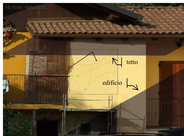
Fig. 18 – Simulazione dell'ombra del tetto e dell'edificio adiacente
